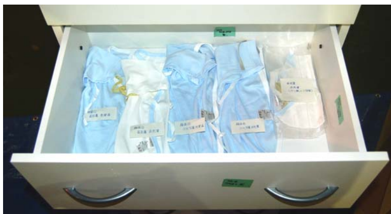
写真9 ホルムアルデヒドの移染試験の状況 (24時間設置する際には引き出しは閉じている)
