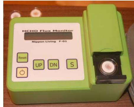
写真1 ホルムアルデヒド発生源検知用シール（柳沢センサー） 写真2 ホルムアルデヒド放散量測定器（HCHO FLUX MONITOR F-01）
